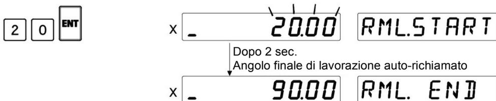
Fase 7 Inserire l'angolo finale di lavorazione, quindi premere il tasto [ENT]. Il valore visualizzato lampeggia una volta, quindi dopo 2 secondi appare il display per l'inserimento dell'angolo di avanzamento.
