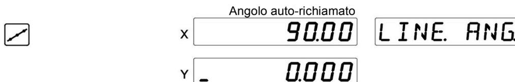
Fase 2 Inserire l'angolo dell'asse X, quindi premere il tasto [ENT]. Il valore visualizzato lampeggia una volta, quindi dopo 2 secondi appare il display per l'inserimento del passo del foro.
