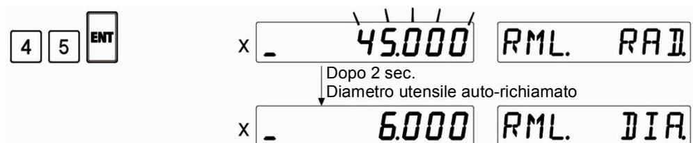
Fase 4 Inserire il diametro dell'utensile, quindi premere il tasto [ENT]. Il valore visualizzato lampeggia una volta, quindi dopo 2 secondi appare il display per l'inserimento della superficie di lavorazione.
