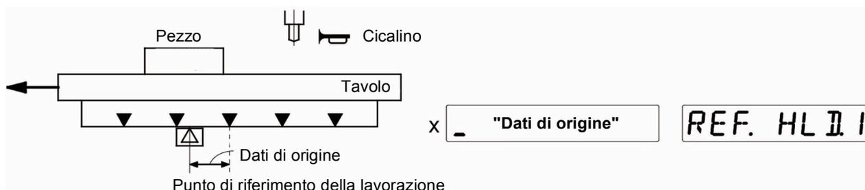
**IMPORTANTE!** • Nel rilevare il punto di riferimento del sistema di misura lineare, spostare la tavola di lavoro a una velocità di avanzamento di 50 mm/s o inferiore. Se la tavola di lavoro si sposta più velocemente di 50 mm/s, l'errore di misura aumenta.
