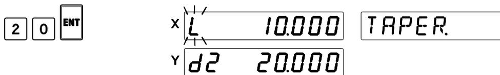
Fase 4 Inserire la distanza tra i due punti del cono "L" quando l'indicazione "L" è illuminata. Il risultato del calcolo della conicità viene visualizzato dopo aver premuto il tasto [ENT] .
