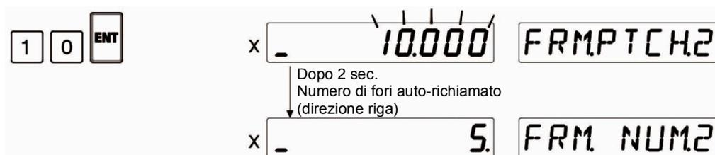
Fase 6 Inserire il numero di fori (direzione riga), quindi premere il tasto [ENT]. Il valore sul display lampeggia una volta, e successivamente il display principale indica il punto di partenza (0,0) mentre il display secondario indica il numero di lavorazione e il numero totale. In questo esempio, il display indica la 1° lavorazione su un totale di 200.
