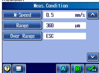
➤ El margen de medición seleccionado se visualiza en la pantalla del menú de las condiciones de medición.
