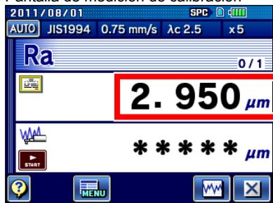
**1** Compruebe el valor normal en la pantalla de medición de calibración.
