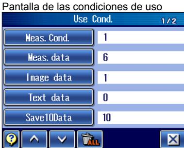
Para borrar los datos guardados en la tarjeta SD por tipo, siga el siguiente procedimiento.
