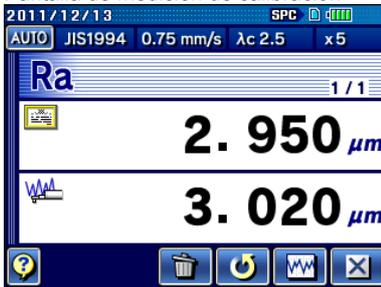
7 Para comprobar la forma de onda, pulse
