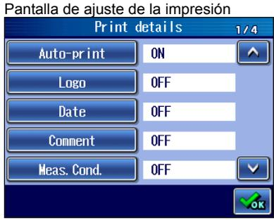
**3** Pulse los elementos a imprimir. Ejemplo: Se seleccionan el logo, la fecha y las condiciones de medición.
