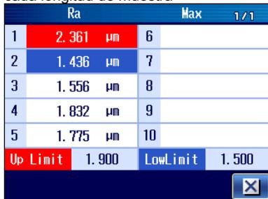
4 Compruebe los resultados de medición en cada longitud de muestra y los resultados de evaluación GO/NG. Cuando los resultados de medición están por encima del límite superior en cada longitud de muestra, la parte de la longitud de muestra aparece en rojo. Cuando los resultados de medición están por debajo del límite inferior, la parte de la longitud de muestra aparece en azul.
