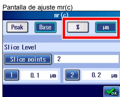
**3** Pulse el tipo de medición del nivel de corte a seleccionar.
