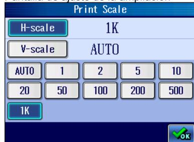
➤ La ampliación horizontal establecida se muestra en la pantalla de ajuste de la impresión.
