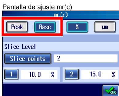
**2** Pulse la referencia del nivel de corte a seleccionar.
