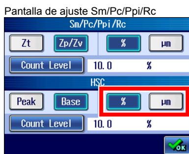
**3** Pulse el tipo de medición del nivel de conteo a seleccionar.
