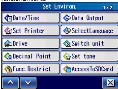
Pantalla de ajuste de la unidad de accionamiento **2** Pulse la unidad de accionamiento para usarla, después pulse
