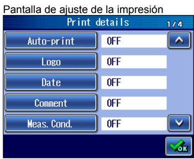
**2** Establezca la función de impresión automática en ON u OFF. La impresión automática es una función que imprime inmediatamente el resultado de medición después de que éste se haya producido. Al pulsar el botón
