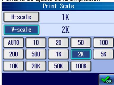
➤ La ampliación vertical establecida se muestra en la pantalla de ajuste de la impresión.
