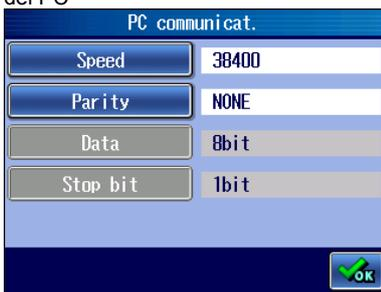
Pantalla de ajuste de la velocidad de comunicación **3** Pulse la velocidad de comunicación, después pulse
