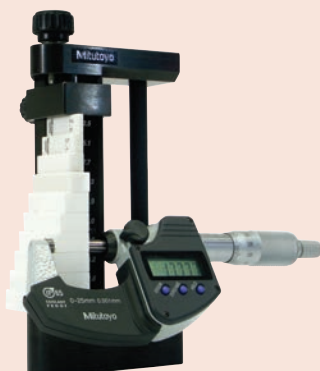
Mikrometerprovare 516-607 Passande passbitssatser 516-156-xx, 516-157-xx, 516-158-xx
