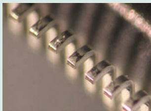
Mätexempel: Höjdmätning av anslutningar på en QFP-kapsel
