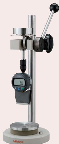
Provningsstativ - Bordets dimension: Ø90 mm - Max.höjd arbetsstycke: 90mm
