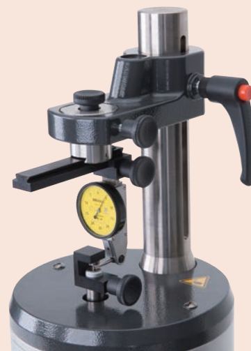
Kalibrering av vippindikator med specialtillbehör
