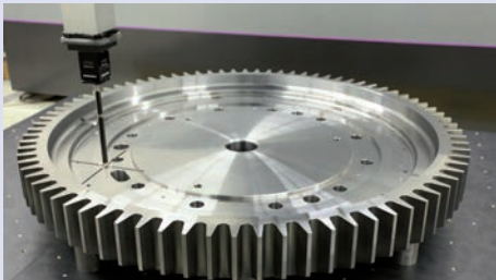
Scanning med prob SP80 och 100 mm mätpets
