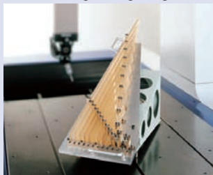
Mätmaskinskalibrering med hjälp av glasmaster med näranog ingen termisk expansion
