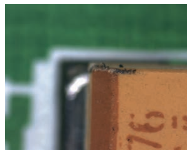
Normal mikroskopobservation (övre) Med en höjdskillnad kan endast det övre eller nedre planet fokuseras.
