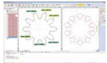
Exempel på växelkonturmatchning och analys av "over-pin"-diameter
