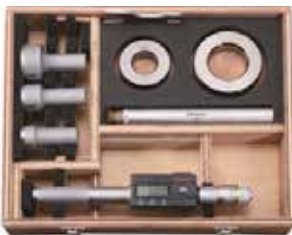
Invändig 3-punktsmikrometer med utbytbara mät huvuden kräver ny referensinställning efter utbyte av mät huvud.
