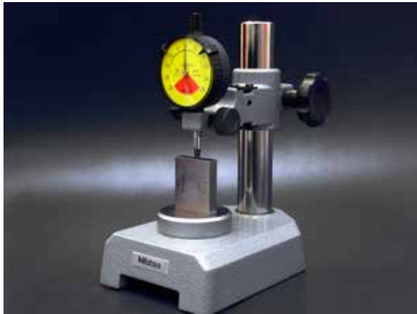
Referenspunktsinställning med en 50 mm passbit.
