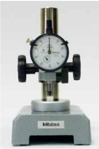
Nollställning med en 10 mm keramisk passbit om arbetsstyckets nominella storlek är 10 mm
