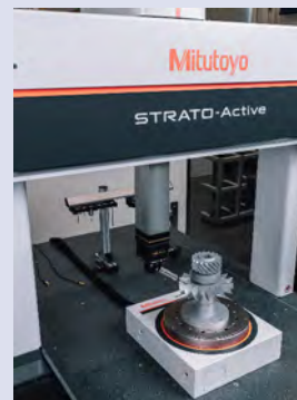
STRATO-Active med rotationsbord MRT320
