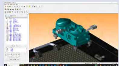
Tillagda stödpunkter och klämmor
