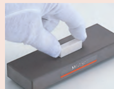
Avlägsna utstående kanter och grader
