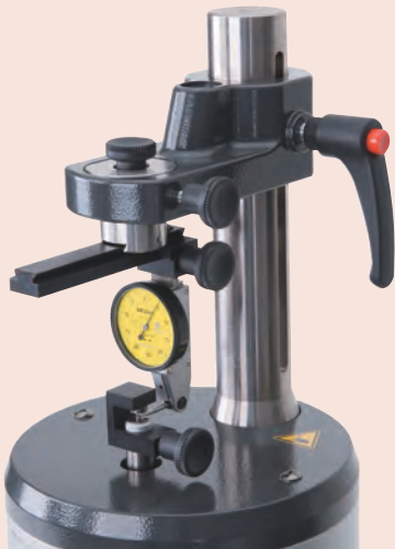
Kalibrering av vippindikator med specialtillbehör
