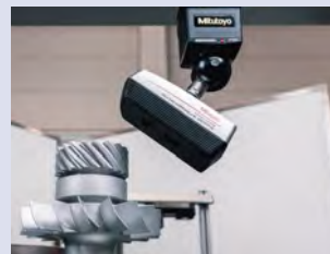
Flying spot-modellen kan scanna svåruppmätta detaljer, såsom denna impeller, och det med klassens högsta scanningnoggrannhet.
