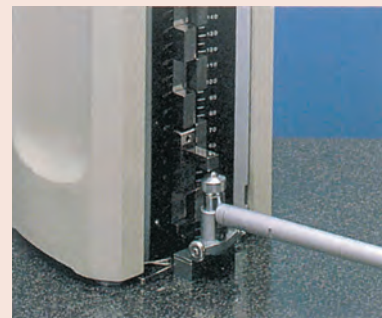
Referensinställning av hållindikator
