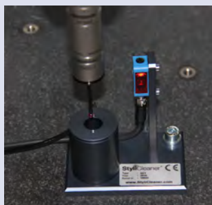
StyliCleaner: Alltid tillförlitlig och ren mätpets
