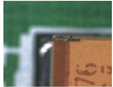
Normal mikroskopobservation (övre) Med en höjdskillnad kan endast det övre eller nedre planet fokuseras.
