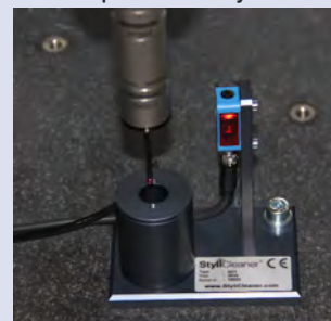
StyliCleaner: Alltid tillförlitlig och ren mätpets
