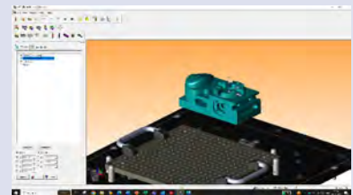
Importerad CAD-fil och utvald basplatta
