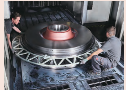
Exempel med det justerbara verktygsstödet vilande mot detaljen
