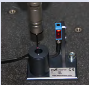
StyliCleaner: Alltid tillförlitlig och ren mätpets
