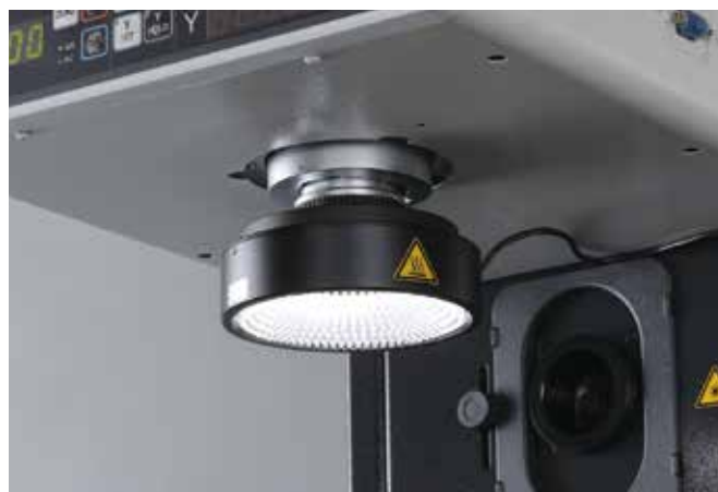
Exempel på montering av den cirkulära LED-belysningen på PJ-PLUS
