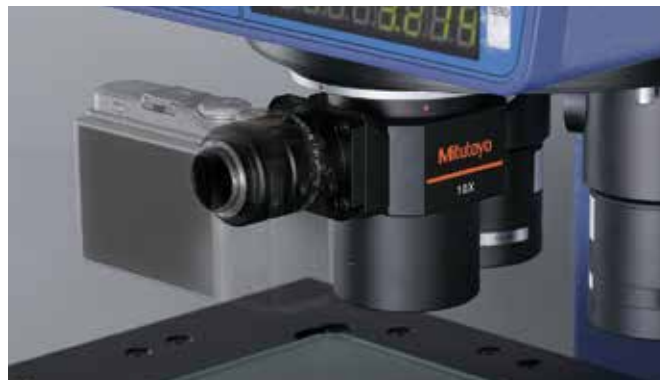
Exempel på fäste av projektlinsen 10X med C-fäste på PJ-H30
